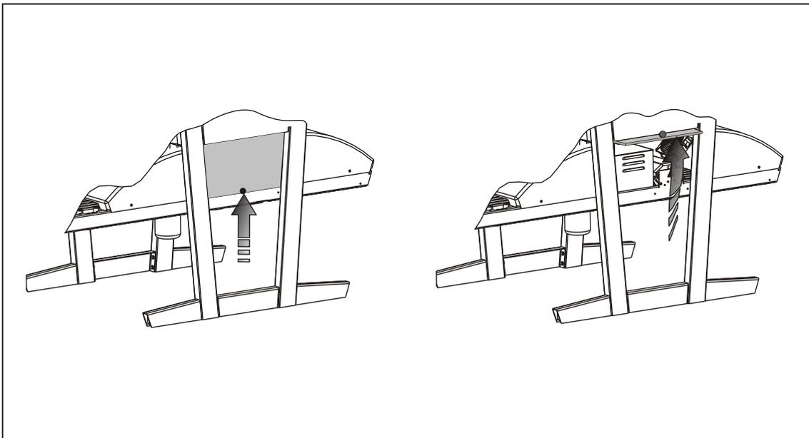
**!** Siempre reemplace la placa lateral después de la limpieza y mantenimiento de la sección del acabador. Si no se hiciera esto, se produciría una calidad inferior de procesamiento.
