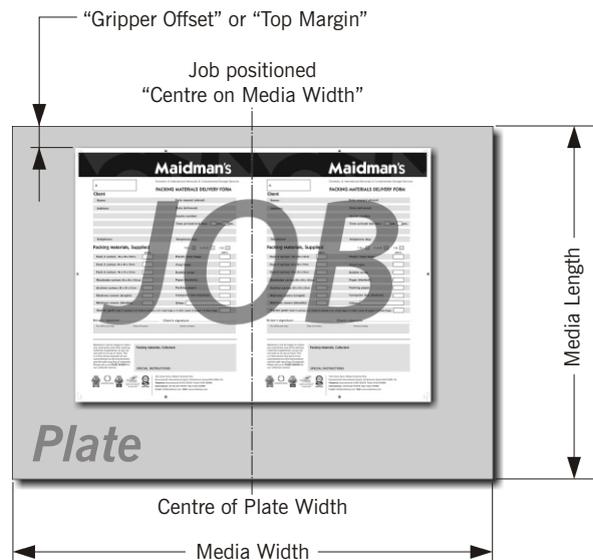
Para prensas de formato horizontal, donde la placa se imprime en formato vertical, el archivo PostScript o pdf por lo general estará centrado en **Media Length** (Longitud del medio) y el valor de **Left Margin** (Margen izquierdo) será **Gripper Margin** (Margen del sujetador), más la flexión de la placa.
