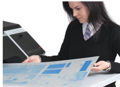
Se utiliza la tecnología inkjet para aplicar una imagen Liquid Dot™ sobre planchas de aluminio no fotosensibles, de grano convencional.
