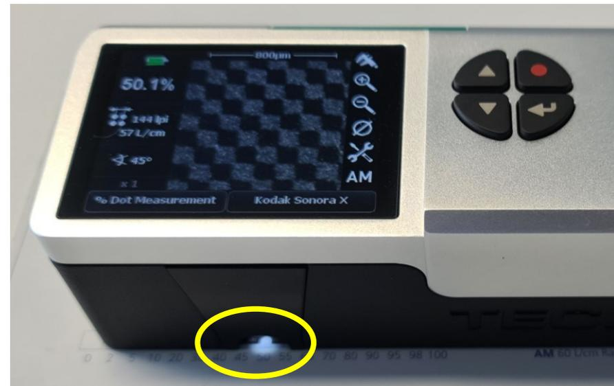
Diferencia en la iluminación en una plancha normal: Izquierda SpectroPlate Start, Derecha SpectroPlate All-Vision. La luz visible en el All-Vision se usa solo para su adecuado posicionamiento.
